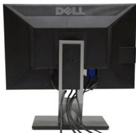
Dopo aver fissato tutti i cavi al monitor e al computer, (Si veda [Collegamento del Monitor](#) per i collegamenti dei cavi,) usare il passacavi per organizzare i cavi in maniera ordinata, come mostrato sopra.
